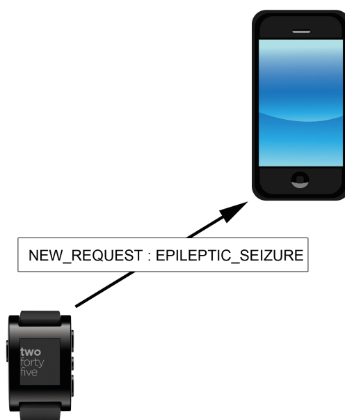
Figura 5.6: La richiesta di assistenza tra smartwatch dell'ospite e dispositivo mobile associato
